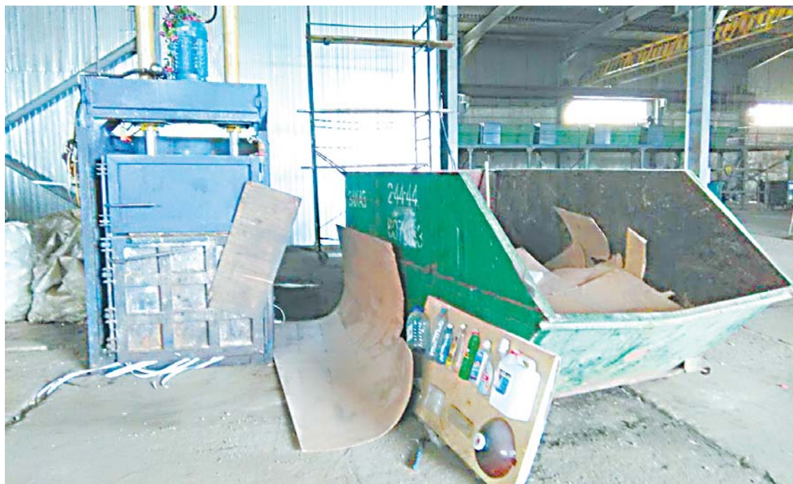
Это пресс для компоновки пластика, собранного в нашем городе. Он делает из него кубы, которые затем отправляются на переработку. Из получившегося продукта можно сделать многое: от наполнителя для подушек до красивого литого заборчика.
