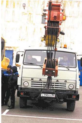
Монтажно-стреловой подъемник. Укладка трубопровода, а также электросетей в траншею – вот главные задачи этой машины. Она справляется с ними на ура. Летом во время ремонта коммуникационных и тепловых сетей без нее никуда.
