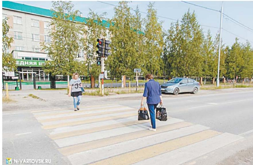
В этом году в Нижневартовске в качестве эксперимента на нескольких пешеходных переходах нанесли разметку из «холодного пластика». Этот материал обладает износостойкостью и отражающими свойствами. В темное время суток разметка хорошо видна водителям и прослужит долгое время.
